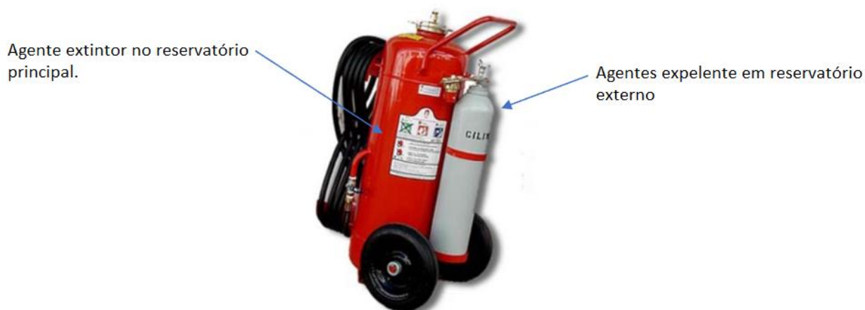
Figura 1.3: extintor sobre rodas com carga de água, de pressurização indireta.
