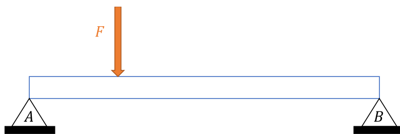
Viga biapoiada com carga concentrada
