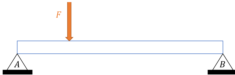
Viga biapoiada com carga concentrada
